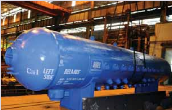
HRSG Drum supplied by BHEL for Grodno Power Project, Belarus
